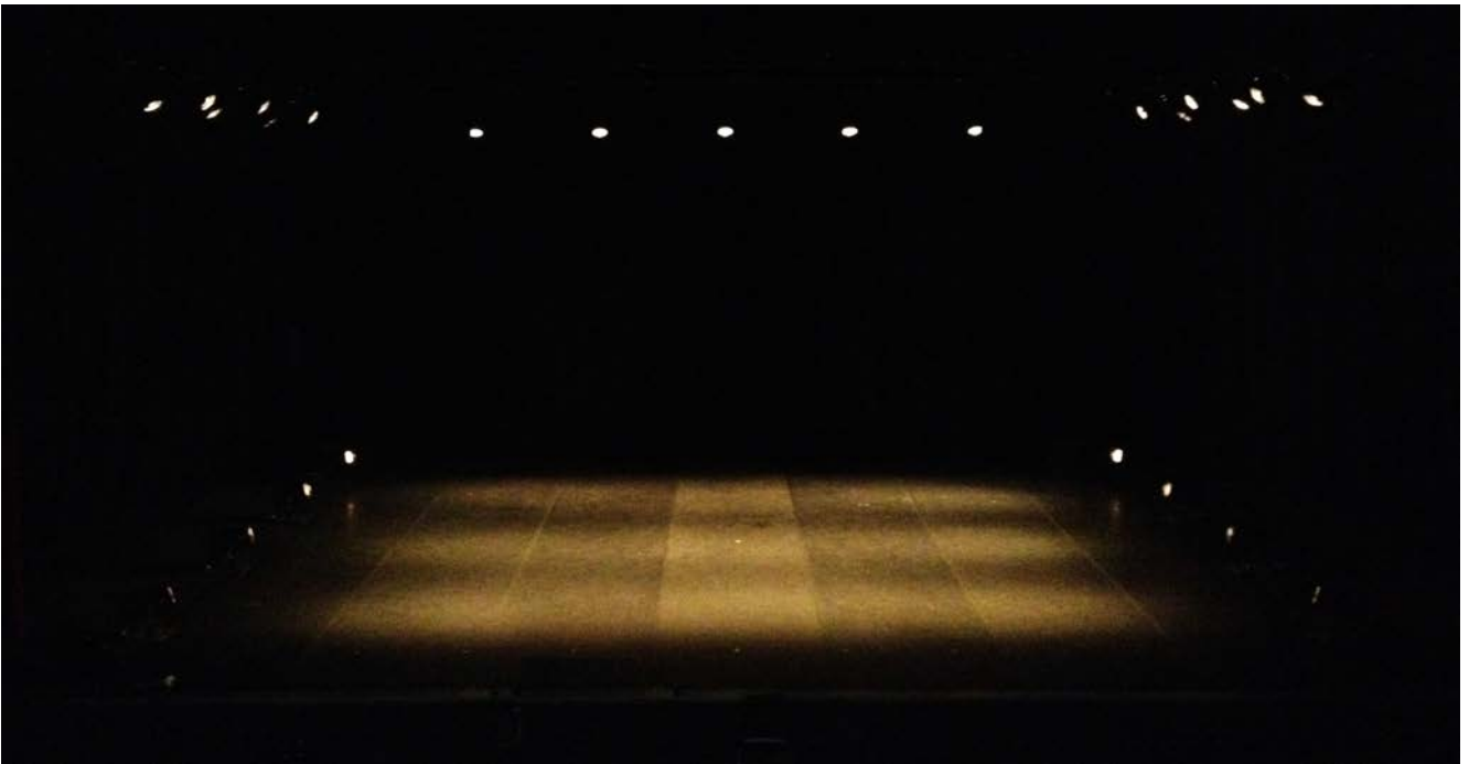
Vue du marquage au sol des latéraux avec zone d'ombre entre les plans
